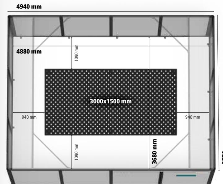
**Cellule de soudure laser 4880x3680 mm**
