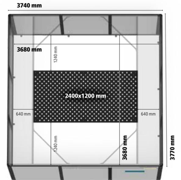
**Cellule de soudure laser 3680x3680 mm**
